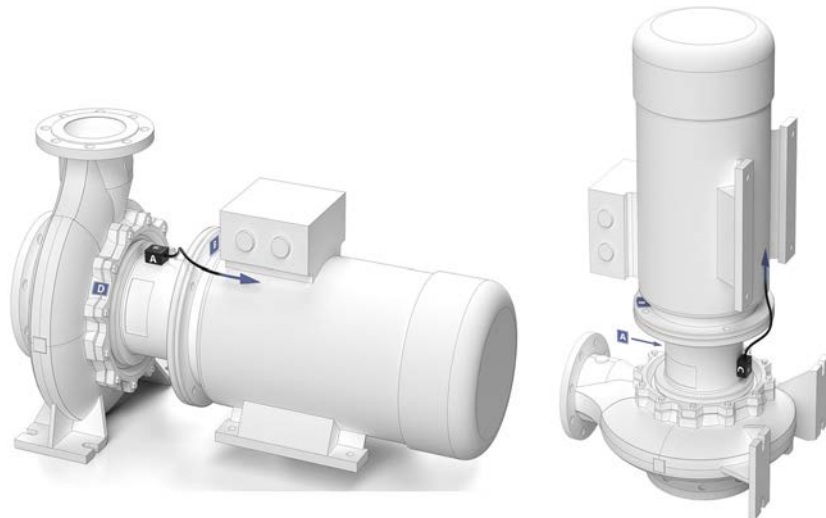
Abb. 15: Horizontale und vertikale Aufstellung Etabloc mit Sensoreinheit
