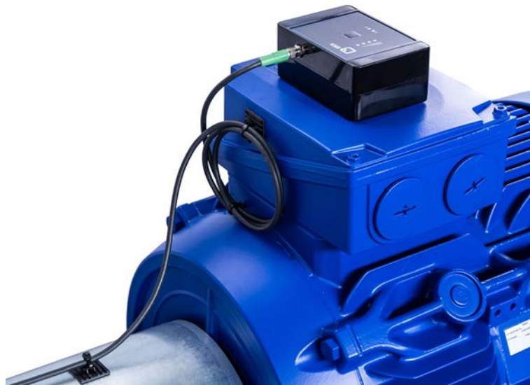
Abb. 10: Elektrische Verbindungsleitung verlegen
